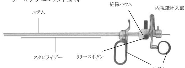
3. 内視鏡を内視鏡挿入部から挿入し、固定する。
