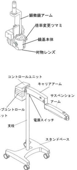
(上図は 180 度可変鏡筒を取り付けた状態)
