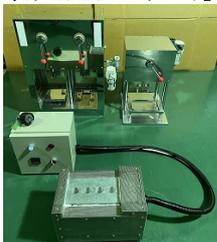
原理：熱可塑性レジンにヒーターで加熱軟化させ、射出・加圧することにより成型する。
