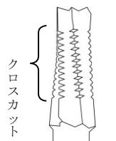
作業部はファインクロスカットで、ブレードに細かな間隔で刻み（クロスカット）が入れてある。
