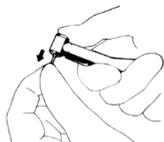
静止状態で親指でヘッドキャップを強く押し、同時にバーを取り外す。
