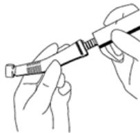
ハンドピースに歯科用モータ（別品目、以下モータ）をカチッとはまる音がするまで挿入し、次にガイドスタッフがカチッとはまる音がするまで回す。ハンドピースを引っ張り、確実に接続されていることを確認する。
