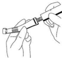
ハンドピースに歯科用モータ (別品目、以下モータ) をカチッとハマる音がするまで挿入し、次にガイドスタットがカチッとハマる音がするまで回す。ハンドピースを引っ張り、確実に接続されていることを確認する。
