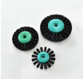
作業部(研磨部)：作業部はプラスチックセンターに研磨用豚毛を植毛したレーズ用研磨ブラシ。
