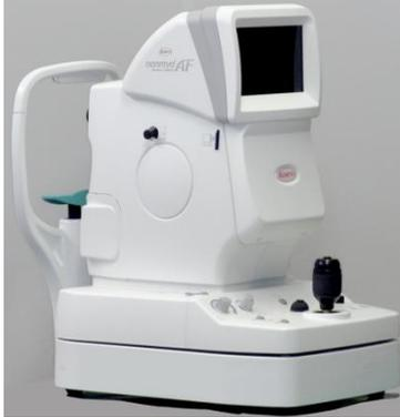
またオートフォーカシング、オートショット機能が搭載されており、モニターで前眼部像を見ながら被検眼と本機器とが適正な位置関係になるように位置調整が行われると、自動的にモニターに被検眼底が表示される。続いて自動でピント合わせがおこなわれ、終了後自動で撮影用光源が発光し、デジタルカメラにより眼底像の撮影が行われる。
