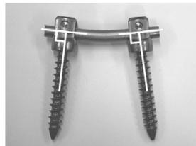
また、脊椎ロッドと脊椎スクリューが直交しない場合でも、閉創前にイメージ等を使用し、脊椎ロッドと脊椎スクリューのヘッドが直交していることを確認すること。脊椎ロッドと脊椎スクリューのヘッドが直交しない状態で固定した場合、インプラントに緩みが発生する可能性がある。
