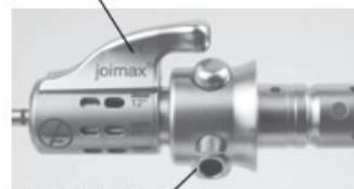
再処理用洗浄ポート
