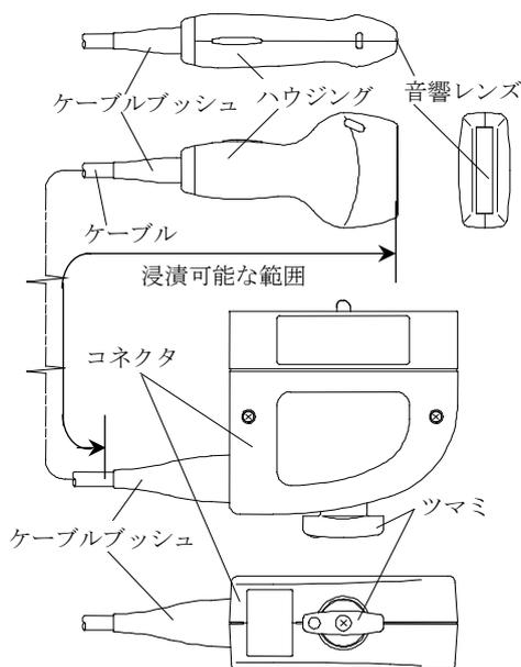
体に接触する部分の原材料：シリコンゴム（音響レンズ）
