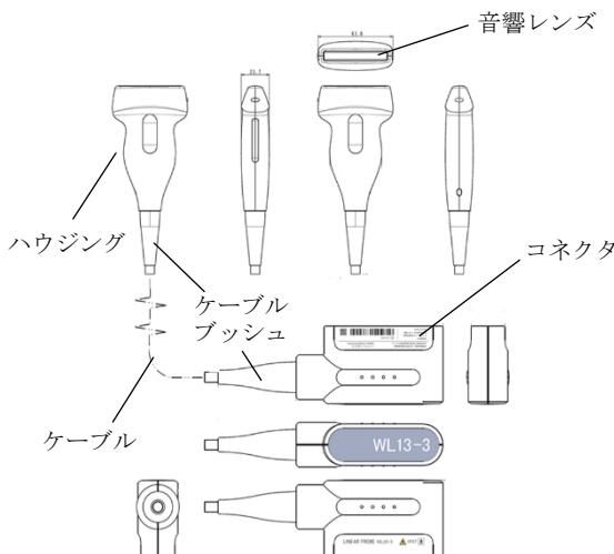
体に接触する部分の原材料：シリコーンゴム（音響レンズ）
