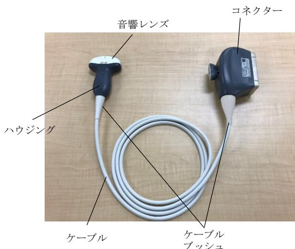
体に接触する部分の原材料：シリコーンゴム（音響レンズ）
