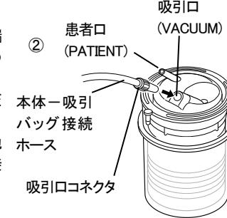
本体-吸引バッグ接続ホースの他方を吸引源に接続してください。(接続が不完全だと必要な吸引圧力を得られなくなることがあります。)
