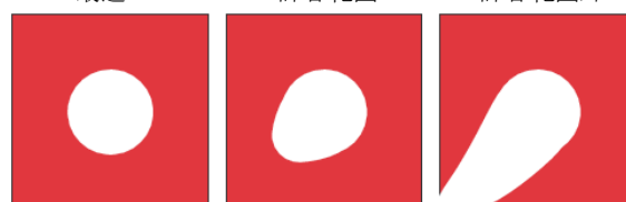
剥離及び切断した光ファイバーの代表的なエイミングビームの画像
