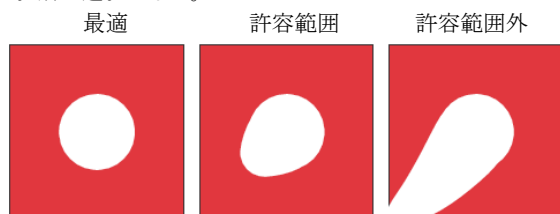
剥離及び切断した光ファイバーの代表的な エイミングビームの画像
