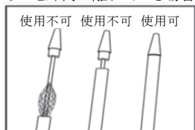
図1: 左側2つの「使用不可」の図は、先端チップと外筒が離れている例。「使用可」の図は先端チップと外筒が接触している正しい状態を示す。
