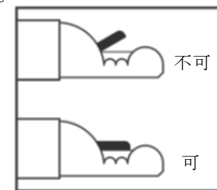
図2: 鉗子起上装置を下げた状態(Open)にあることを確認する。鉗子起上装置を上げた状態(Close)にあるのは不適切であり、カテーテルを進める際の妨げになる。
