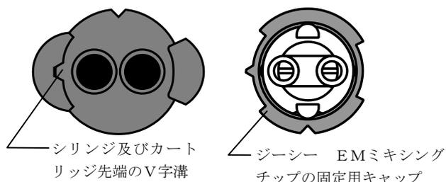
シリンジ及びカートリッジ先端のV字溝
