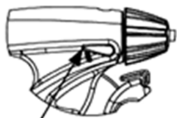
図 a: ロックモード (ロック状態) モードインジケータは赤色
