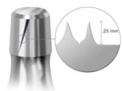
図 A: 0.25mm を超える高さの傷や損傷があるテーパー部分ラニオン
