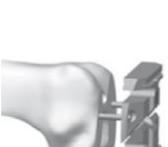
サイジングガイドで作製したホールを用いて、フェモラルカッティングガイドを大腿骨遠位端に設置し、大腿骨の前方顆部、後方顆部、前方シャンファー、後方シャンファーの骨切りをする。
