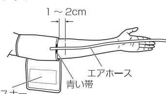
※巻き方が適切でないと、正しく測定できない場合がありますので、巻きつけがゆるすぎたり締め付けすぎたりしないようにしてください。
