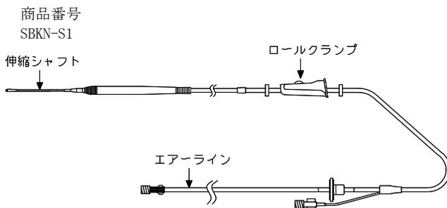
本品はエアーラインを有し、ポンプもしくは配管より送り出されたエアーもしくは CO<sub>2</sub> を本体先端部より噴射させる。
