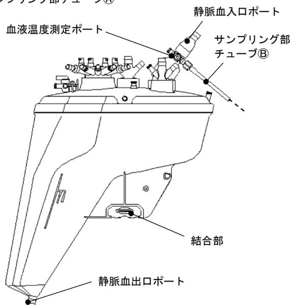
(2) ガス交換部、熱交換部
