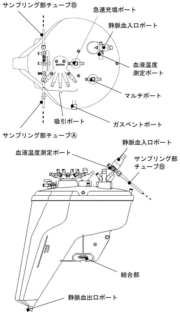
(2) ガス交換部、熱交換部
