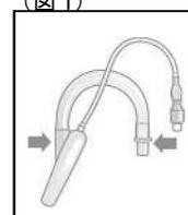
の外端部分にしっかり密着していなければならない。手では容易にコネクタを引き抜くことができないことを確認する。ただし、コネクタの密着を損なうおそれがあるため過剰な力でひいたり、コネクタをねじ曲げたりしないこと。
