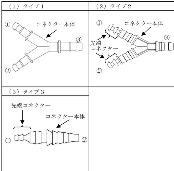
タイプ2及び3は、コネクター本体と先端コネクターを接着剤により接合している。
