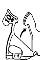
図 4 ニードルガイド取付部の溝に合わせる。
