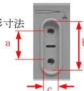
本品に接続するバイポーラコードプラグは電極端子の間隔28.6mmのφ4mm固定プラグを使用すること。
