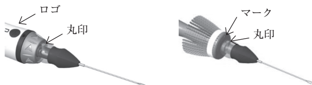
図2：本品根本の丸印がロゴ又はマークに対して一直線であることを確認
