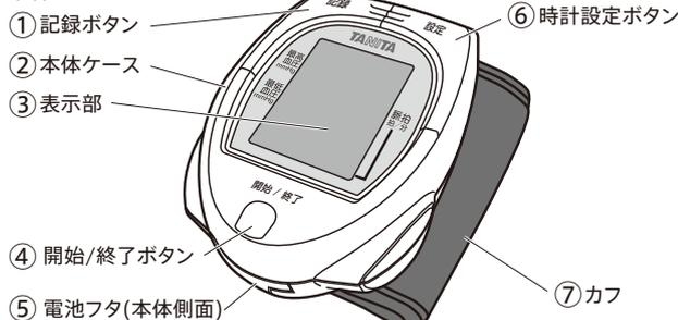
本体の寸法：約 D33mm×W64mm×H87mm
