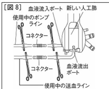
6-5 新しい人工肺を同一径のコネクターを用いて使用中のラインに取り付け、接続箇所はすべて締め具で固定すること(図8)。
