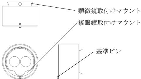
2. 寸法:  $\phi 70\text{mm} \times 51\text{mm}$
