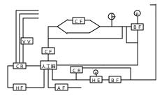
C F:回路洗浄フィルター VV:ベントパルブ BF:血液フィルター TF:トリプルフロー HE:熱交換器 AF:エアーフィルター HF: ヘモコンセントレーター P: 圧力測定回路 CR:貯血槽
