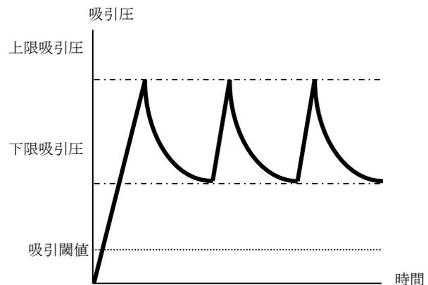
吸引開始：吸引ポンプ作動約4-5秒で吸引閾値に達し、吸引を開始する。曲線は吸引圧変動の概略を示す。
