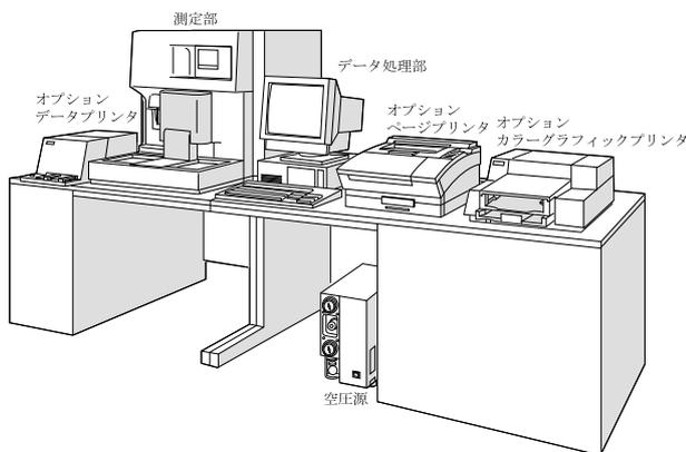
オプションとしては 100 検体サンプル(またはコンベアシステム)、エアフィルタ、排液監視ユニット、消音ボックス、後面カバー。ハンディーバーコードリーダー、データプリンタ、カラーグラフィックプリンタ、レーザープリンタ、患者情報プログラム、本体 2 台接続プログラム、アップグレードプログラム XE pro があります。
