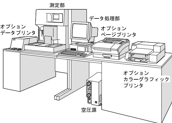
オプションとしては 100 検体サンプラ（またはコンベアシステム）、エアフィルタ、排液監視ユニット、消音ボックス、後面カバー、ハンディバーコードリーダ、データプリンタ、カラーグラフィックプリンタ、レーザプリンタ、患者情報プログラム、測定部 2 台接続プログラム、アップグレードプログラム XE pro があります。
