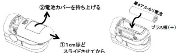
②極性に注意して単4アルカリ電池1本を本体に挿入し、電池カバーを元に戻します。この時、電池カバーに描かれた▲(三角)マークの先端と電池ケース内に描かれた位置決め線が一致する位置からパチンと音がする位置まで約1cmスライドさせます。
