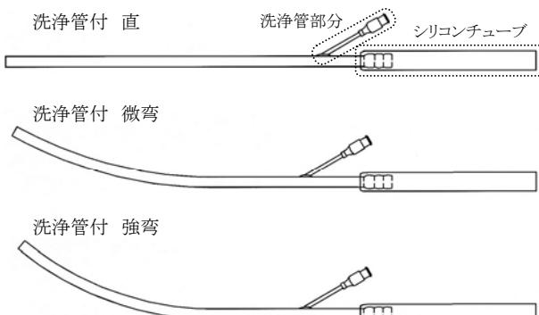
材質:ステンレス、真鍮、シリコン(シリコンチューブ部分)
