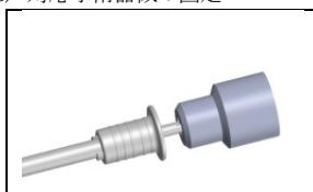
チャックアダプターのつば部を解除し、対応手術器械を固定する。(取り外しの際はチャックアダプターのつば部を引いた状態で対応手術器械を引き抜き、つば部を解除する。)
