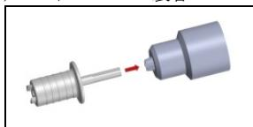
チャックアダプターの後端三面取り部をハンドピースに固定する。
