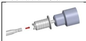
チャックアダプターのつば部を引いた状態で、対応手術器械の後端接続部をチャックアダプターの先端接続部に合わせて押し込む。
