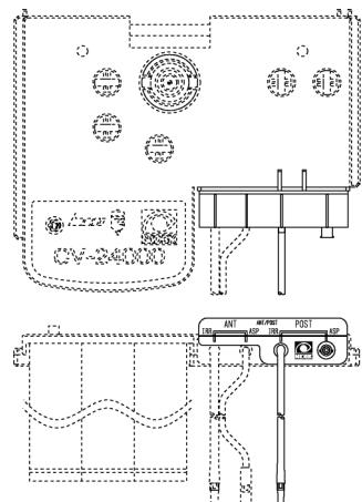
接続口寸法 : 85mm(W)×21mm(D)×26.5mm(H)
