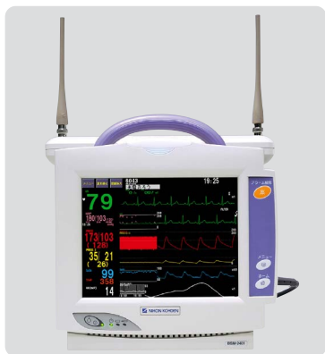
写真は、ベッドサイドモニタ本体に本体付属品のアンテナとアンテナ基台を接続した状態です。
