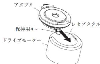
図 1 アダプタを人工心肺装置 S5 に装着する
