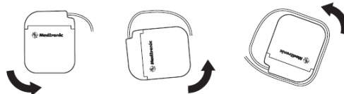
図 3: 反時計回りに回転させて余分なリード又はアダプタを巻く
