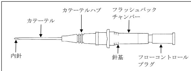
インサイト-Nのタイプは内針に側孔が設けられており、低い静脈圧下でフラッシュバックチャンバーへの血液の逆流を待たずに、血管確保を刺入部で確認することができる。
