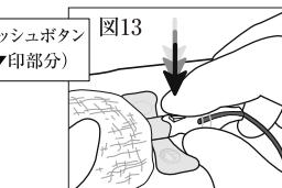
注意：穿刺部位からフロントバ렐の先端までを滅菌ガーゼで確実に覆ってから、安全装置を作動させること。[滅菌ガーゼによる覆いが不十分な場合、安全装置作動時に血液飛散が発生するおそれがある。]
