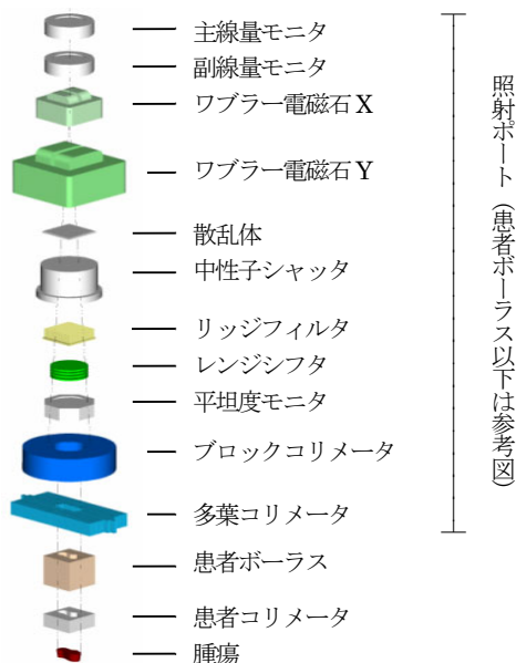
図-3 照射ポート (ワブラー方式) の構成
