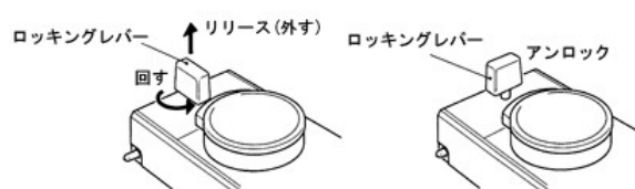
マニホールドから気化器を外す(アンロックする)
