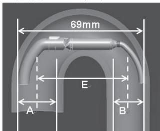
有効な大動脈弓の幅（上図69mm）=上行大動脈の内径「A」の1/2+中心線での大動脈弓の幅「E」+下行大動脈の内径「B」の1/2
